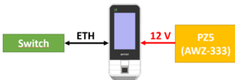
Obr. 9: Zálohovatelný 12 V zdroj
