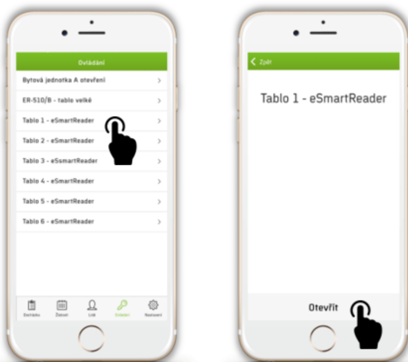
Obr. 14: Proces Nuceného otevření dveří se snímačem
