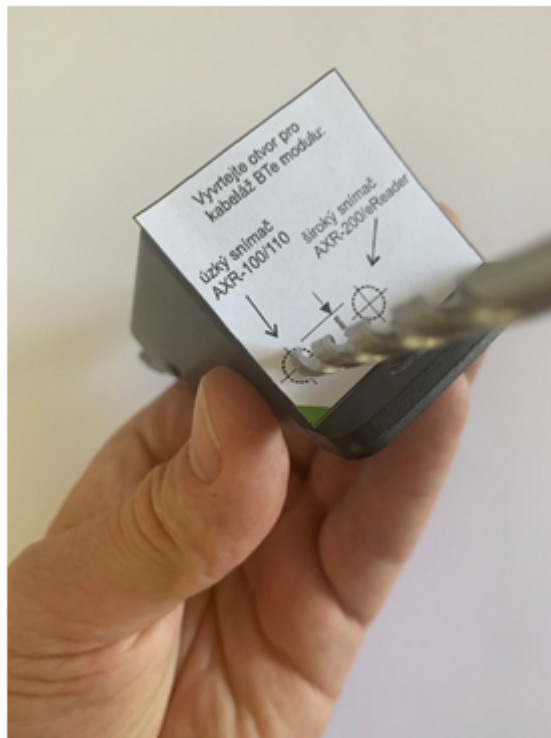
Obr. Vrtání otvoru pro úzký kryt (AXR-1xx)
