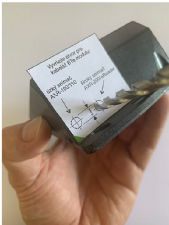
Obr. Vrtání otvoru pro široký kryt (ER, AXR-2xx)
