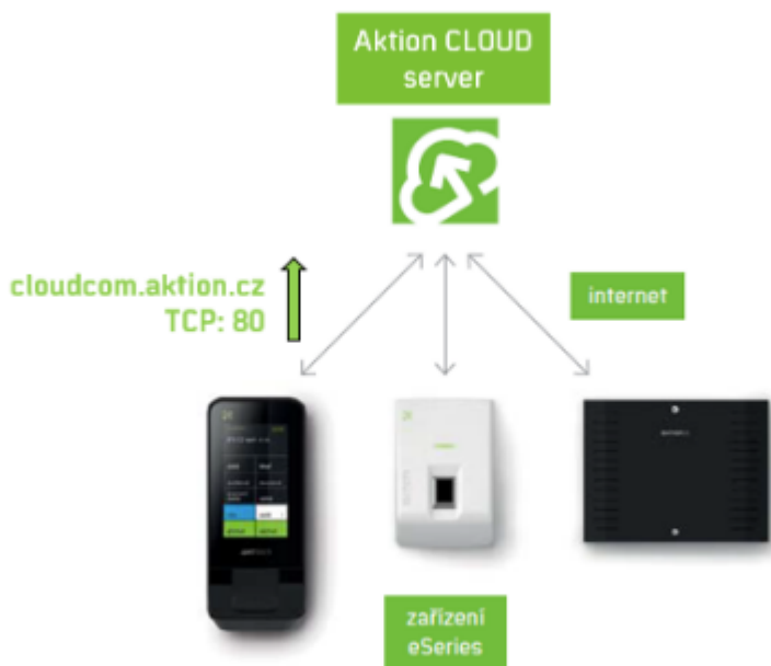
Obr. 18 Schéma zapojení pro Cloud
